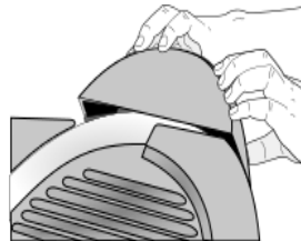
FIG 3. INSTALACIÓN DE AFILADOR
